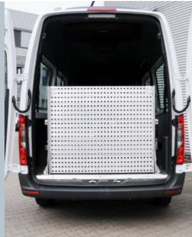
Véhicule avec rampe rabattue. Visibilité vers l'arrière maintenue.
