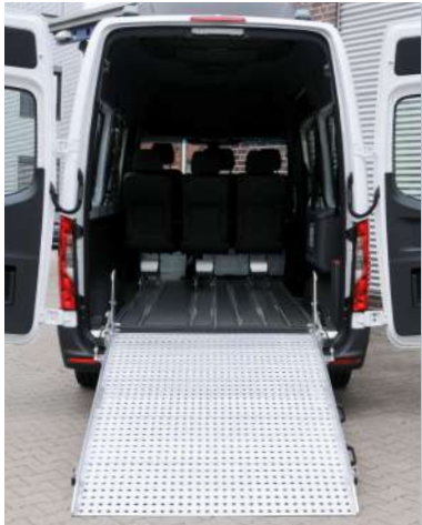
Véhicule avec rampe abaissée, prêt à accueillir les passagers.
