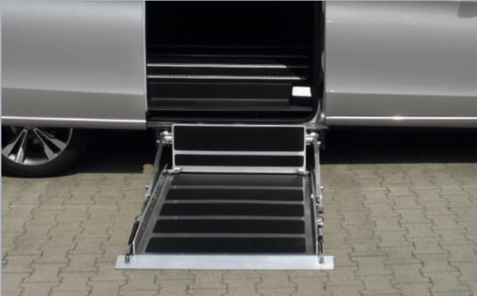
Die automatische Abrollsicherungsklappe und die großzügige Plattform sorgen für zusätzliche Sicherheit.
