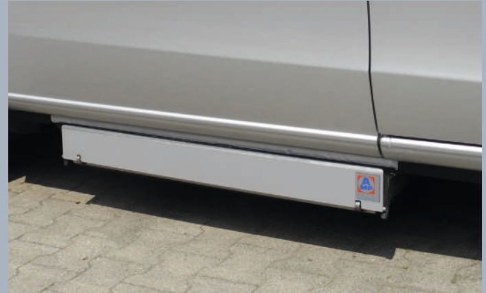
Der ultraflache Kassettenlift garantiert die größtmögliche Bodenfreiheit.
