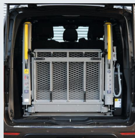
La plateforme "Panorama" permet d'installer un grand élévateur dans des véhicules à faible hauteur intérieure.
