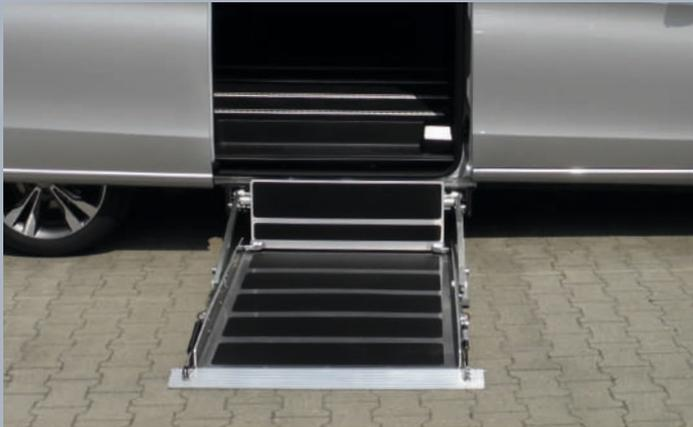
Le volet anti-déroulement automatique et la plateforme spacieuse garantissent un niveau de sécurité optimal.
