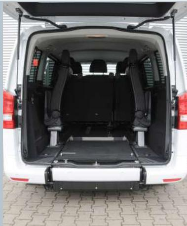
Mit der optionalen **EASYFLEX** Rampe kann der Kofferraum voll genutzt werden.
