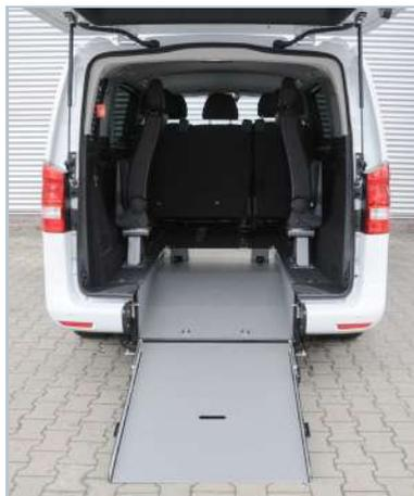
Lorsque la rampe est dépliée, le véhicule devient très accessible en fauteuil roulant.
