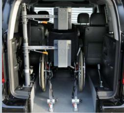
Le véhicule est équipé de l'appuie-tête et du support dorsal FUTURESAFE.
