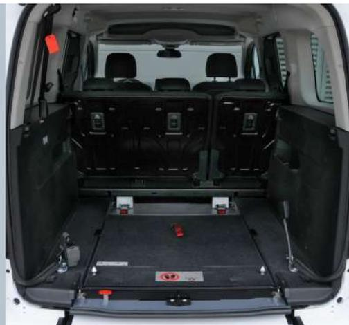
La rampe EASYFLEX repliée permet d'utiliser pleinement l'espace du coffre.
