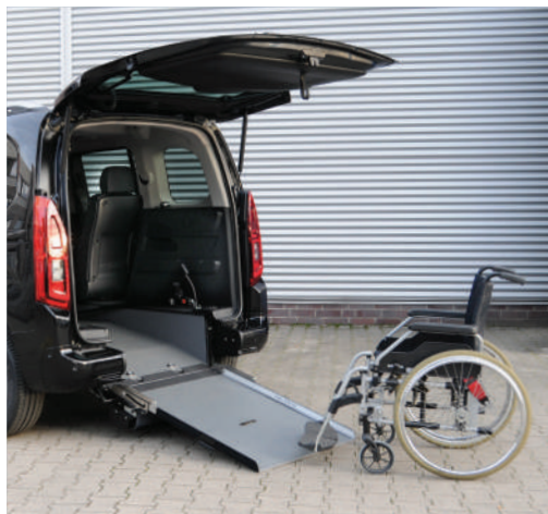
Lorsque la rampe est dépliée, le véhicule est facilement accessible en fauteuil roulant
