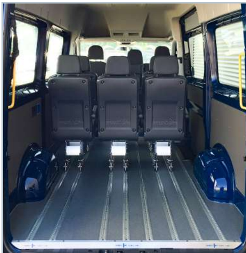
Le système de plancher Smartfloor en aluminium permet une utilisation flexible du véhicule.
