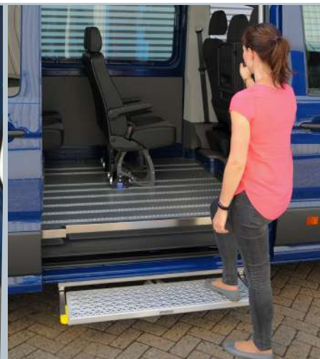
Le marchepied électrique permet un accès latéral confortable.
