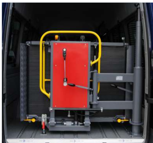
Élévateur pivotant replié dans le véhicule, pour un gain de place optimal
