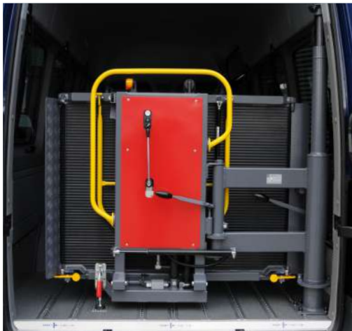
Schwenklift platzsparend ins Fahrzeug eingeklappt.
