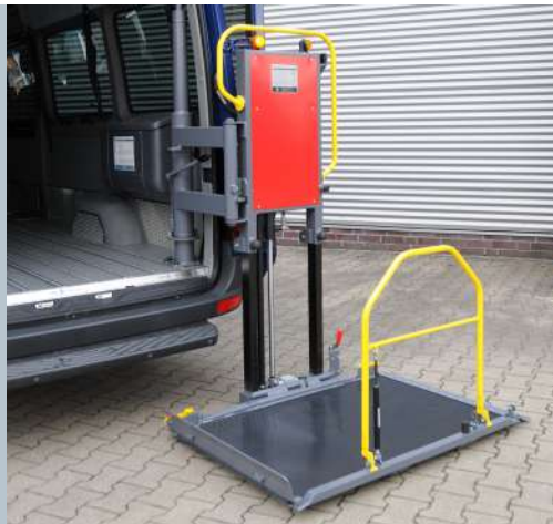
Abgesenkter Lift, zur Aufnahme des Fahrgastes bereit.
