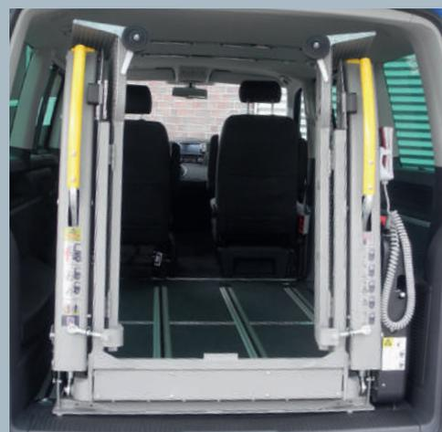
La plateforme "Split" assure une vue dégagée vers l'arrière et permet d'entrer et de sortir facilement par le hayon.
