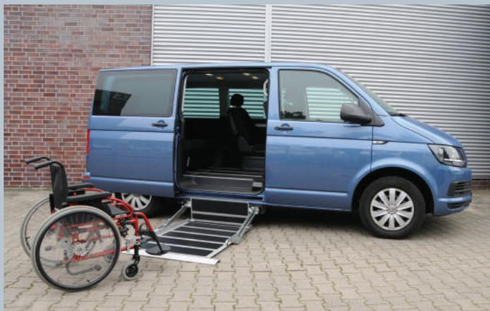
L'option d'accès latérale avec le bord latéral plat de la plateforme de l'élévateur permet de gagner de la place lorsque le fauteuil roulant monte dans le véhicule.
