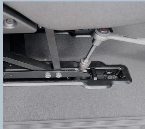
La fixation du siège se fait par vissage
