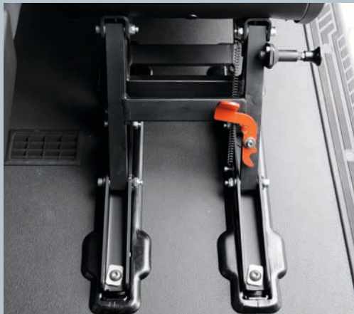
Pédale pour un déverrouillage facile depuis la 3ème rangée
