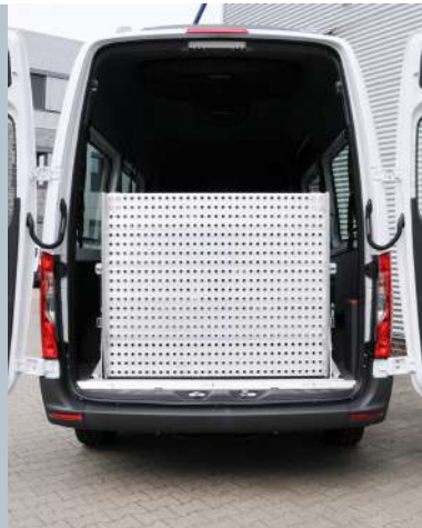
Véhicule avec rampe repliée. La visibilité vers l'arrière est maintenue.
