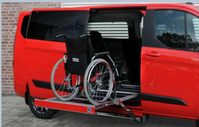
Le clapet anti-déroulement automatique et la plateforme spacieuse assurent une sécurité supplémentaire lors du chargement des passagers en fauteuil roulant
