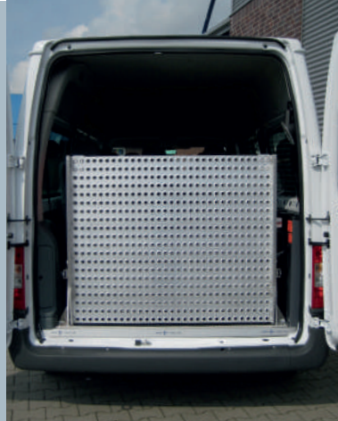
Fahrzeug mit eingeklappter Rampe. Die Durchsicht nach hinten bleibt erhalten.
