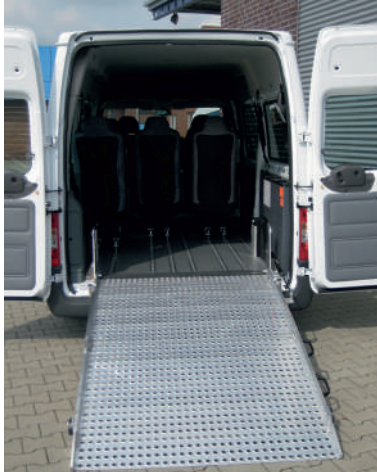
Abgesenktes Fahrzeug zur Aufnahme der Fahrgäste bereit.
