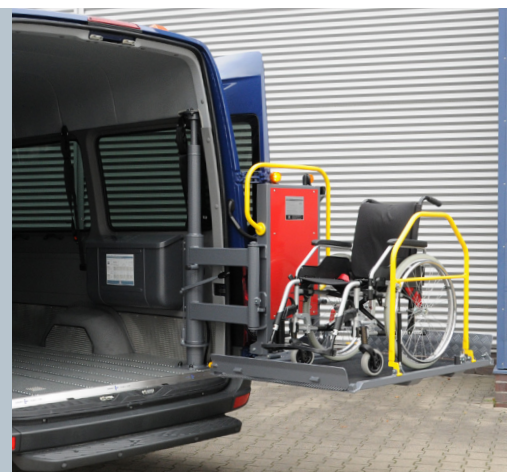
L'élévateur pivotant BSL 350 d'AMF-Bruns en cours de levage du fauteuil roulant
