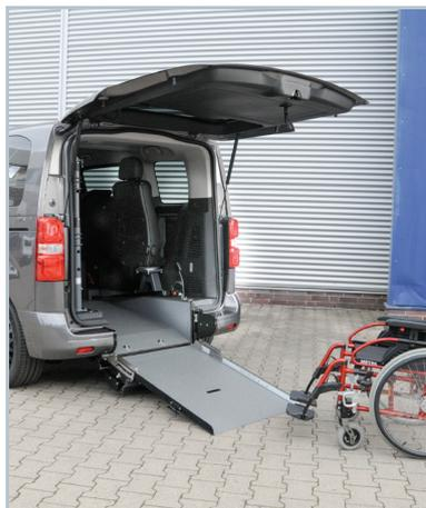
Lorsque la rampe est dépliée, le véhicule est facilement accessible en fauteuil roulant.
