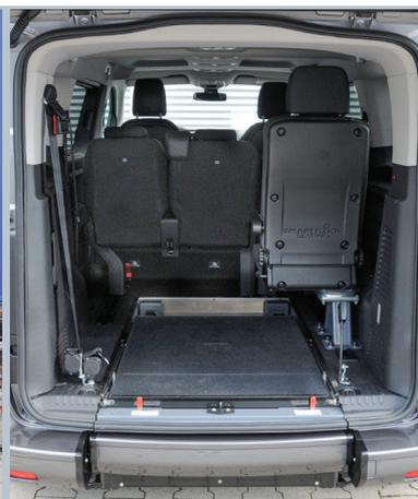
La rampe **EASYFLEX** repliée permet d'utiliser pleinement l'espace du coffre.
