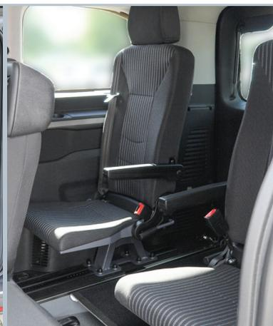
Des sièges pivotants et rabattables en option sur la 3e rangée permettent une utilisation flexible du véhicule.
