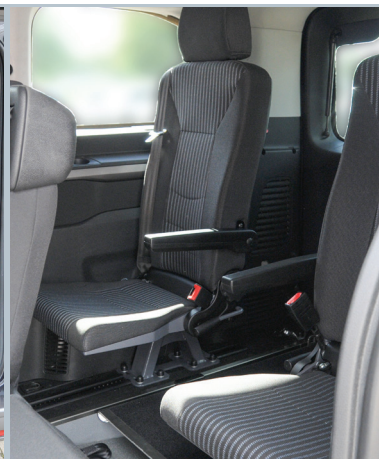
Optionale Dreh-Klappsitze in dritter Reihe ermöglichen eine flexible Nutzung des Fahrzeuges.
